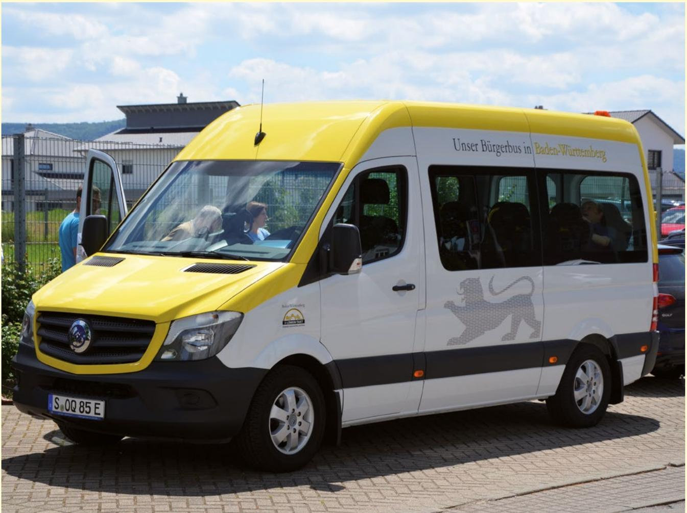
Bild 7: Mercedes Benz Sprinter-Umrüstung von German E-Cars
