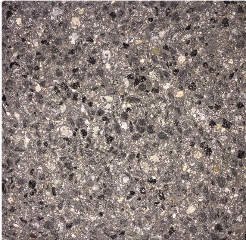
**Abbildung 2 Farbmuster Schwarzgranit Nr. 257, sandgestraht**
