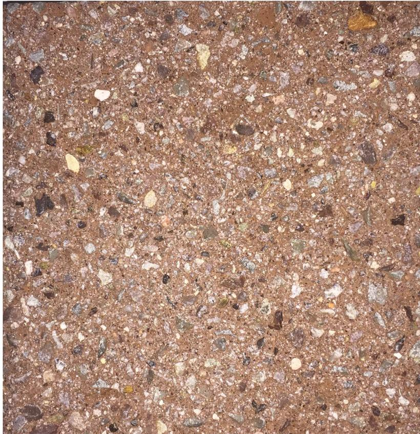
**Abbildung 1 Farbmuster Krophyr Erdbraun Nr. 95, sandgestrahlt**
